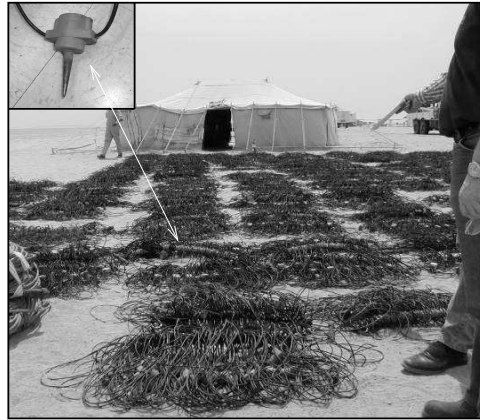
b) Geophones and Cables
