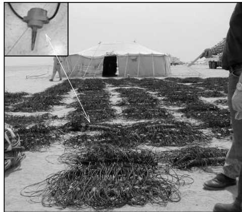
b) Geophones and Cables
